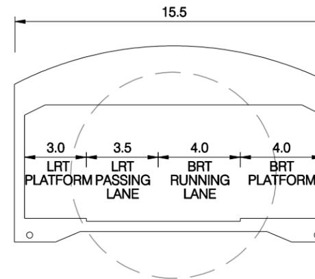
LRT / BRT SECTION ALONG PLATFORM
